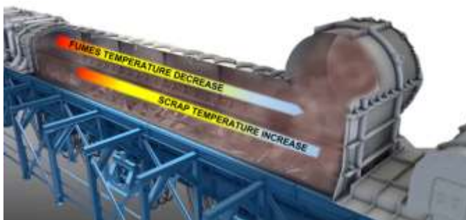
Tunel de preîncălzire
